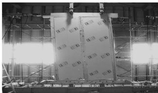
FPパネル筋交いなし：壁倍率 2.66 倍
